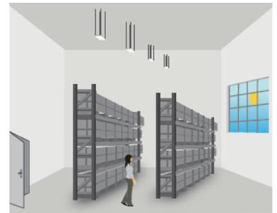
**El sensor apaga la lámpara, si la luz natural es suficiente, incluso con presencia.**
