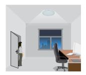
Con luz natural insuficiente, el sensor enciende la Luz automáticamente cuando se detecta la presencia.
