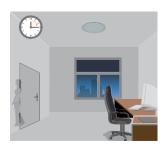
El sensor apaga la luz automáticamente Después del tiempo de espera cuando no se detecta movimiento.
